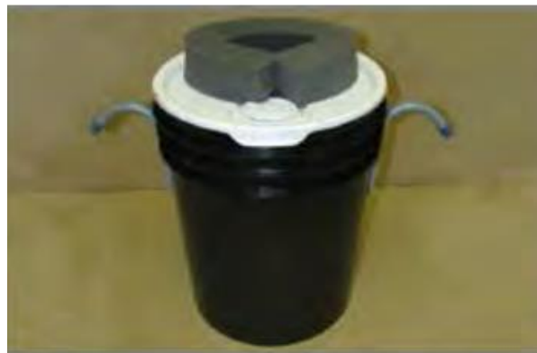
Figure 3 : L'aquascope est un appareil muni d'une lentille translucide (plexiglas) permettant d'observer le fond de l'eau sans l'effet réfléchissant de la lumière à la surface de l'eau. Photo : MDDELCC, 2016
